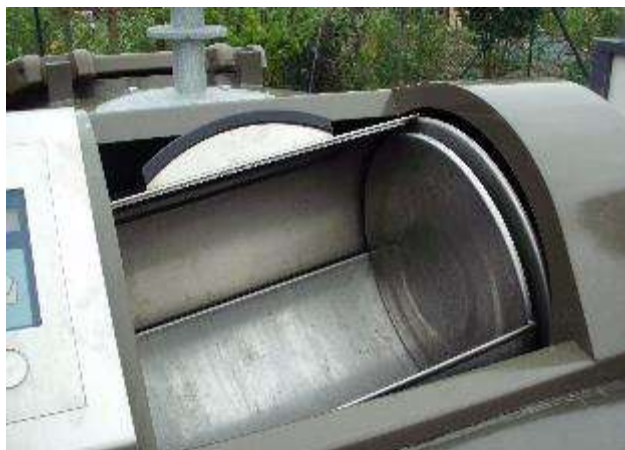
Casse d'usure suite forçage régulier
